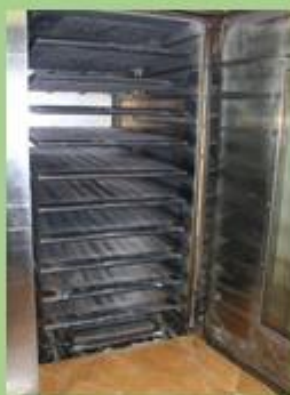
Sur cet exemple, soles à demeure dans le four
