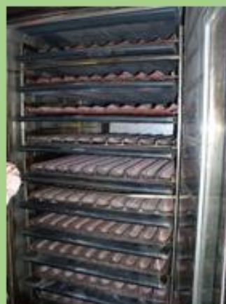
Sur cet exemple, soles à demeure dans le four
